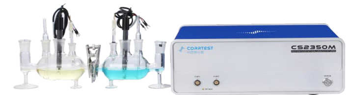
Hydrogen diffusion test
