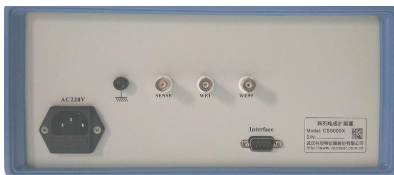
图 1.7 CS5000X 阵列电极扩展器后面板布局
