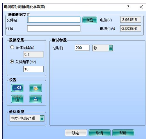
图 3.27 电偶腐蚀测量设置界面
