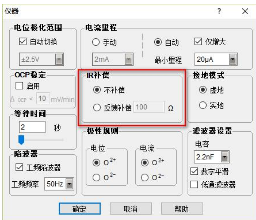
图 3.6 CS Studio 溶液电阻补偿
