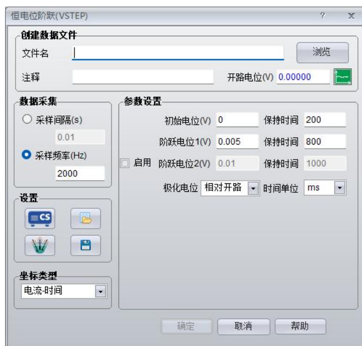
图 3.32 恒电位阶跃参数设置界面
