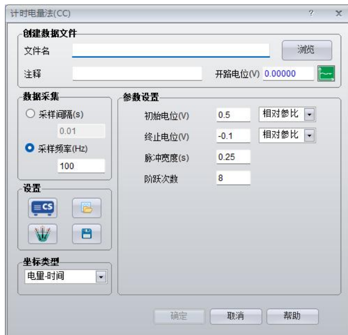
图 3.36 计时电量法参数设置界面
