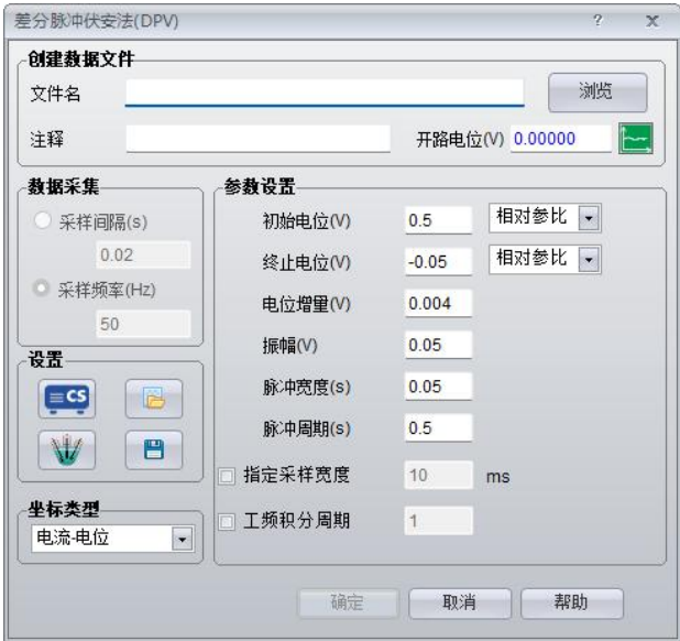
图 3.47 差分脉冲伏安法参数设置界面
