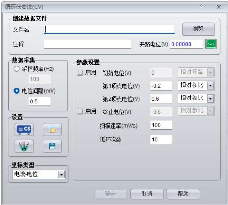
图 3.39 循环伏安法参数设置界面
