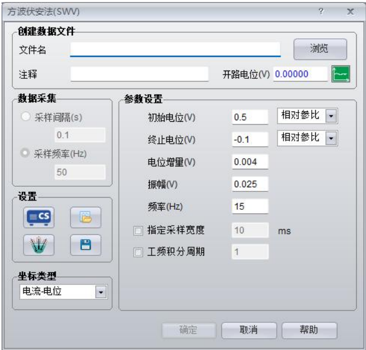
图 3.44 方波伏安法参数设置界面
