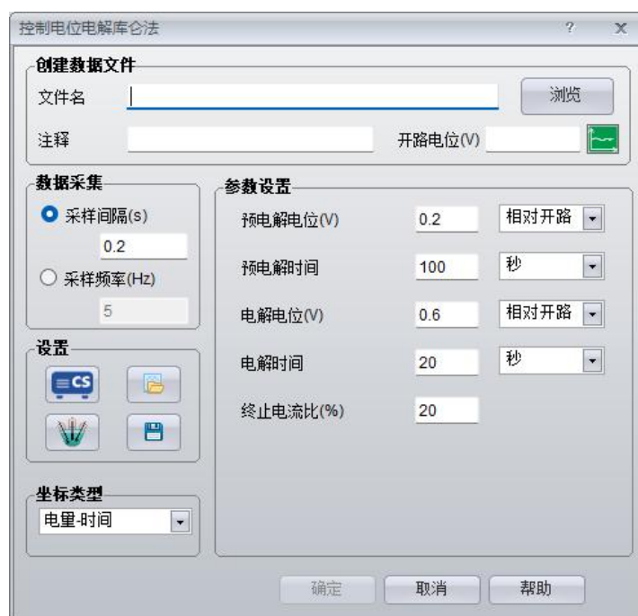
图 3.96 控制电位电解库伦法参数设置界面
