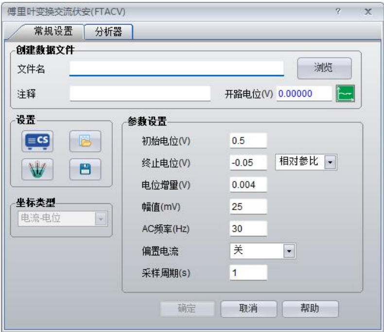
图 3.60 傅里叶变换交流伏安参数设置界面
