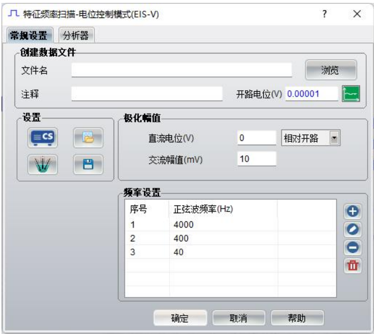
图 3.80 特征频率扫描-电位控制模式设置界面
