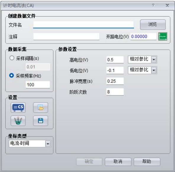
图 3.35 计时电流法参数设置界面
