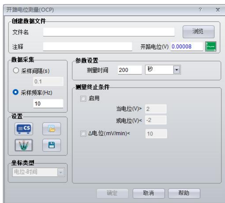
图 3.21 开路电位测量参数设置窗口
