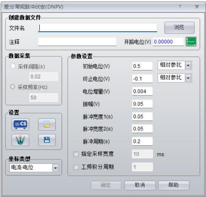
图 3.53 差分常规脉冲伏安参数设置界面
