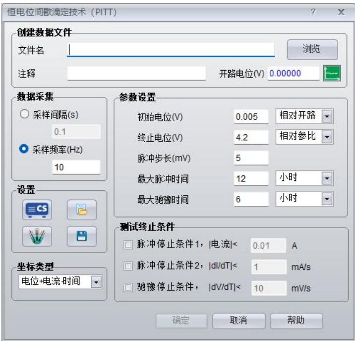
图 3.89 恒电位间歇滴定技术参数设置界面
