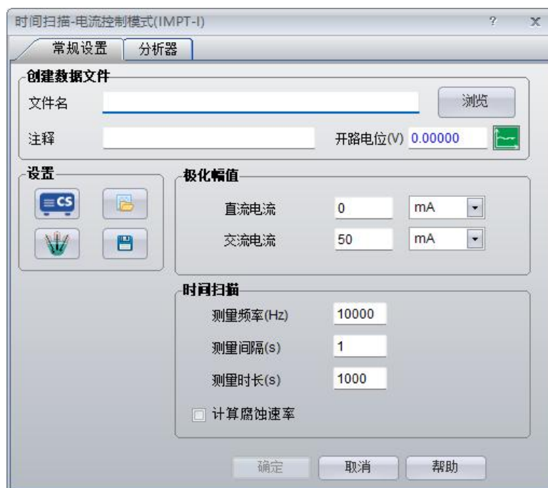
图 3.85 时间扫描-电流控制模式参数设置
